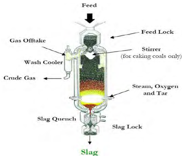
Abbildung 22: British Gas Lurgi (BGL) (/Quelle: /25)
