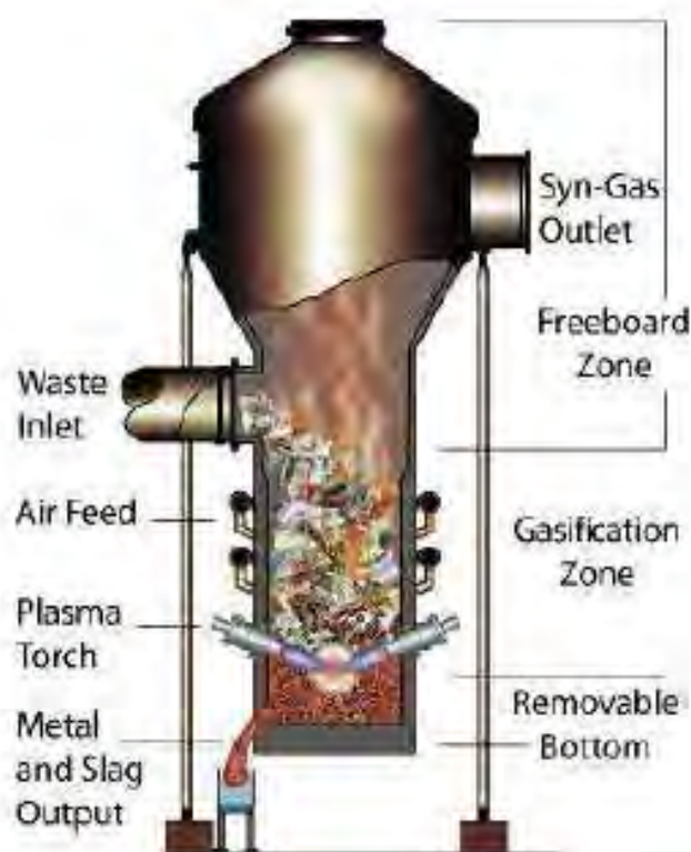
Abbildung 34: Westinghouse Plasma Vergaser (Quelle: /37//)
